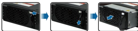
图5 拉出旧PSU模块
