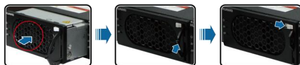
图6 安装新PSU模块
