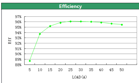
图2 输出效率曲线图 (典型) ( V_{in} = 230 \text{ VAC} , T_a: 25 \text{ }^\circ\text{C} )
